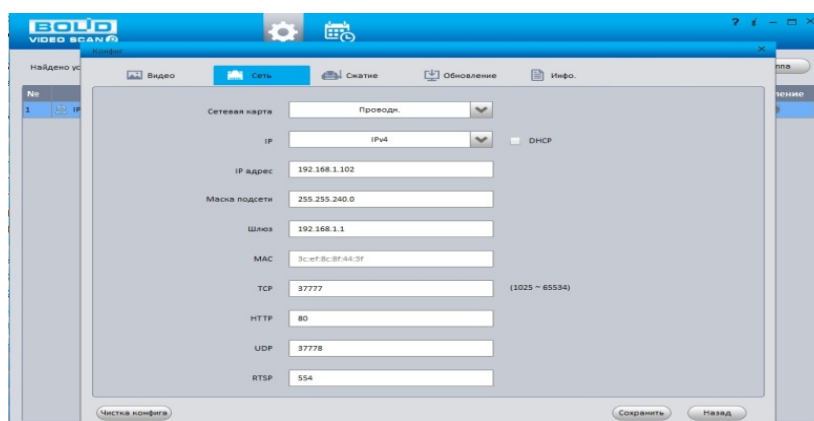
Рисунок 24.2 – Изменение IP-адреса с помощью утилиты «BOLID VideoScan»
