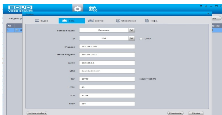
Рисунок 26.2 – Изменение IP-адреса с помощью утилиты «BOLID VideoScan»
