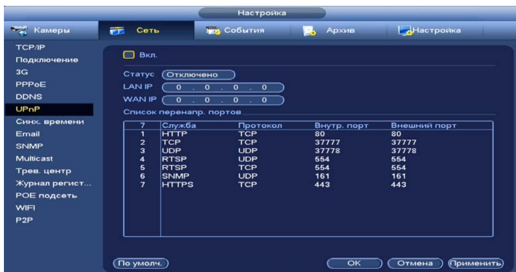
Рисунок 10.5 – Интерфейс настройки «UPnP»
