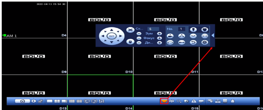
Рисунок 7.1 – Переход в меню PTZ-управления через панель навигации
