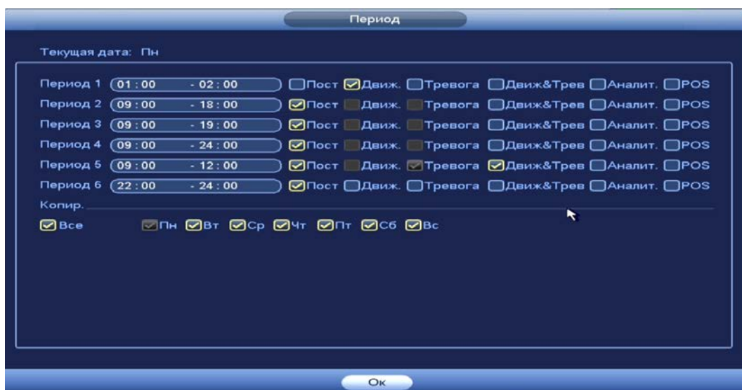
Рисунок 15.5 – Настройка расписания записи
