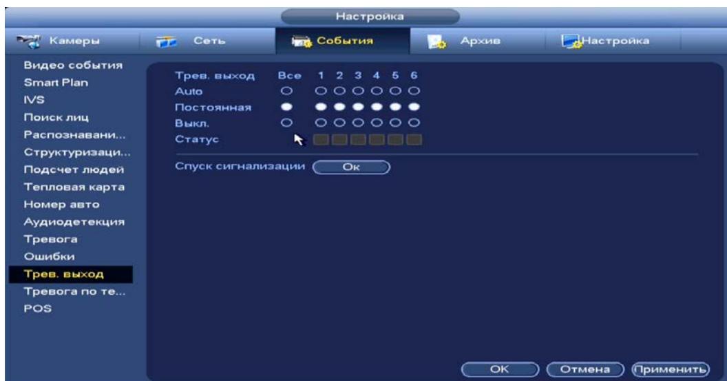
Рисунок 14.12 – Настройка записи по тревожному выходу
