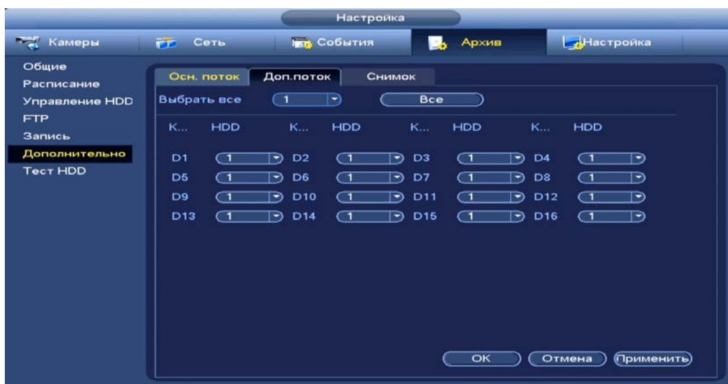
Рисунок 15.15 – Интерфейс выбора HDD для доп. потока
