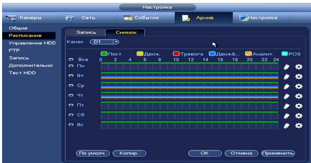
Рисунок 15.8 – Настройка расписания снимка на устройстве
