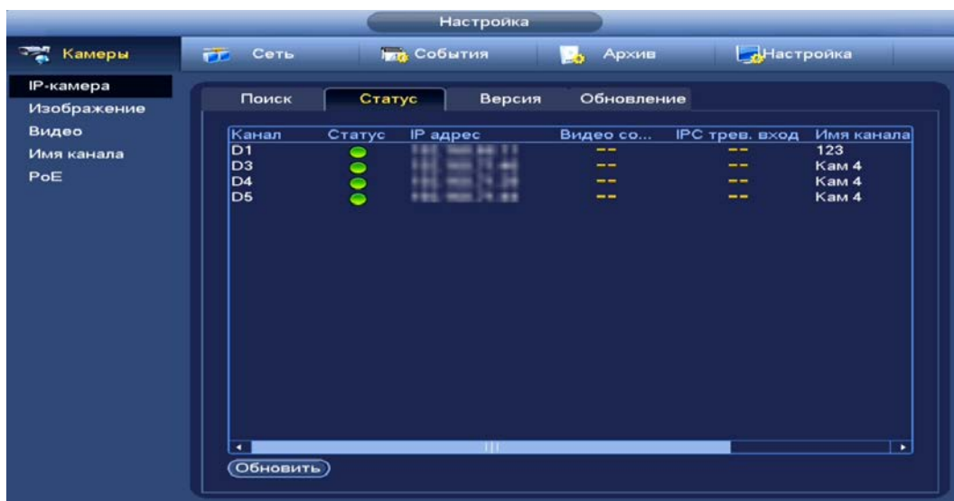
Рисунок 11.13 – Интерфейс просмотра подключенных устройств
