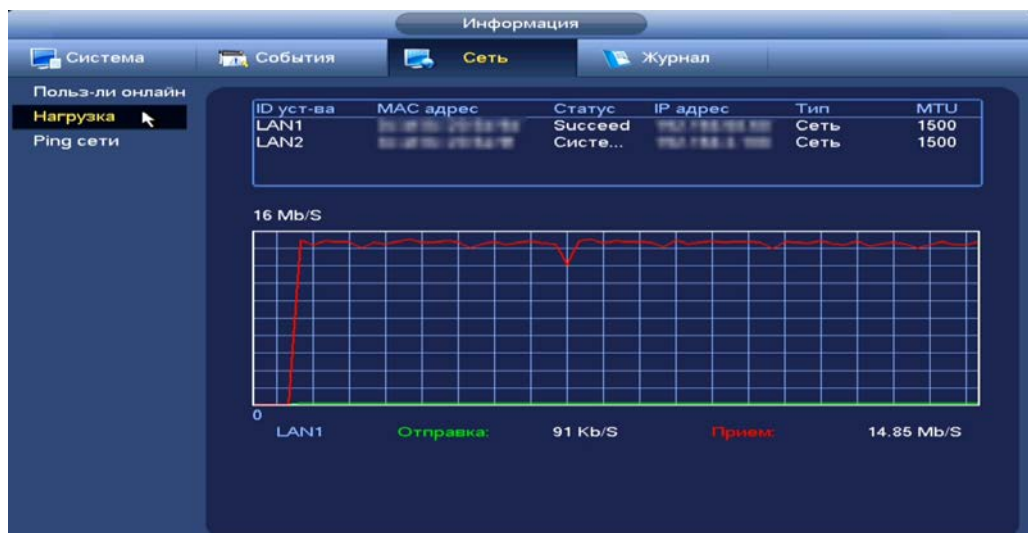
Рисунок 11.17 – Интерфейс просмотра нагрузки
