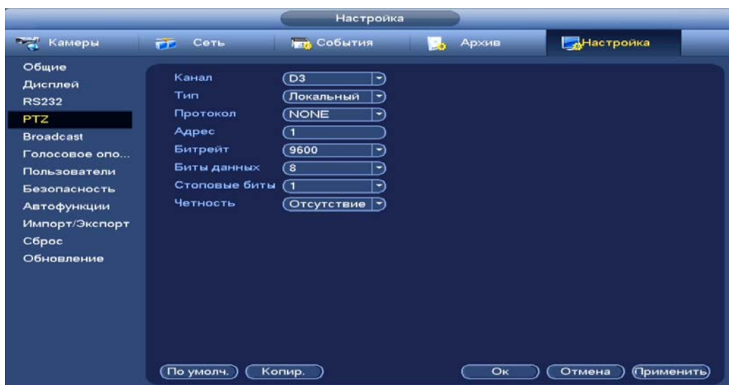
Рисунок 7.9 – Локальное PTZ подключение
