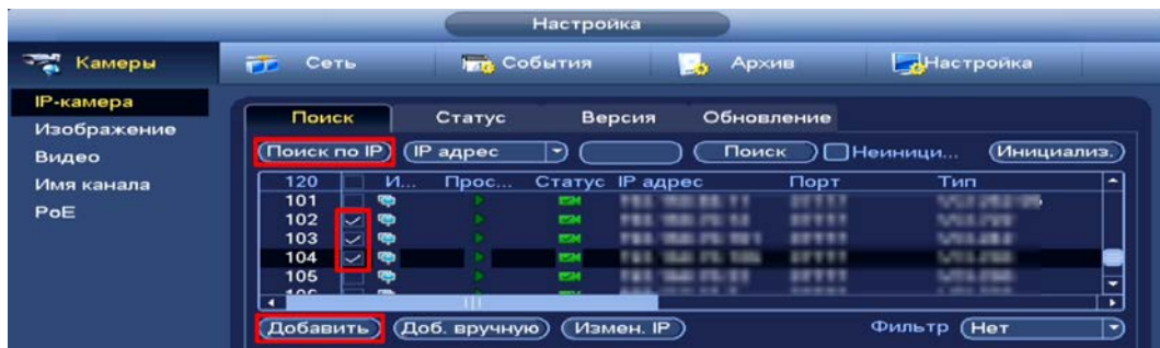
Рисунок 11.5 – Автоматический поиск и добавление камеры на устройство
