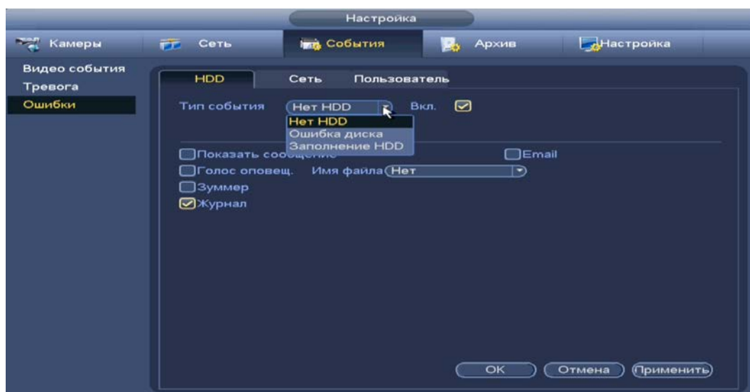
Рисунок 17.4 – Интерфейс настройки оповещения об ошибках HDD
