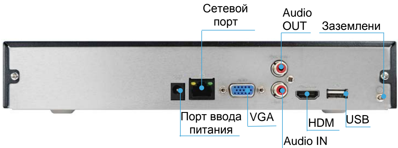
Рисунок 3.2 – Внешний вид задней панели
