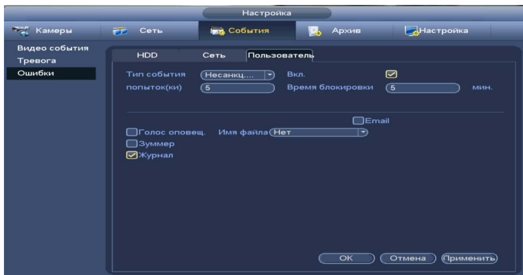
Рисунок 17.6 – Интерфейс настройки оповещения о несанкционированном доступе
