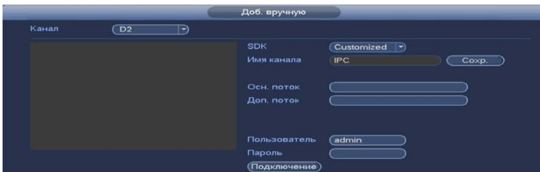
Рисунок 10.8 – Подключение к стороннему RTSP потоку
