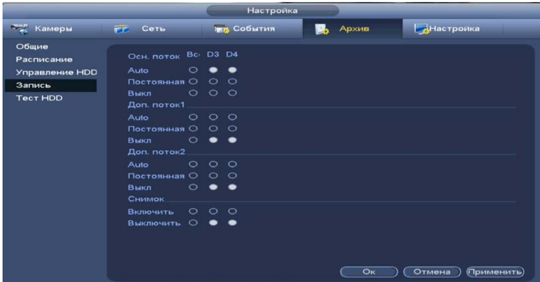
Рисунок 14.7 – Интерфейс настройки записи Дополнительно для перехода в меню перейдите «Контекстное меню => Активация => Запись».
