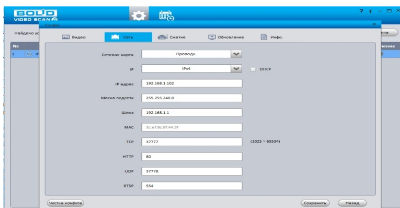
Рисунок 27.2 – Изменение IP-адреса с помощью утилиты «BOLID VideoScan»
