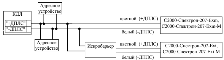
Рис. 2 – Типовая схема включения извещателя в двухпроводную линию связи КДЛ
