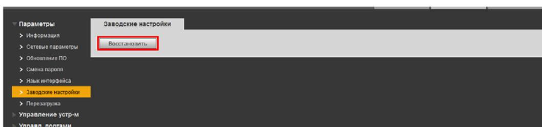
Рисунок 6.9 – Сброс до заводских параметров
