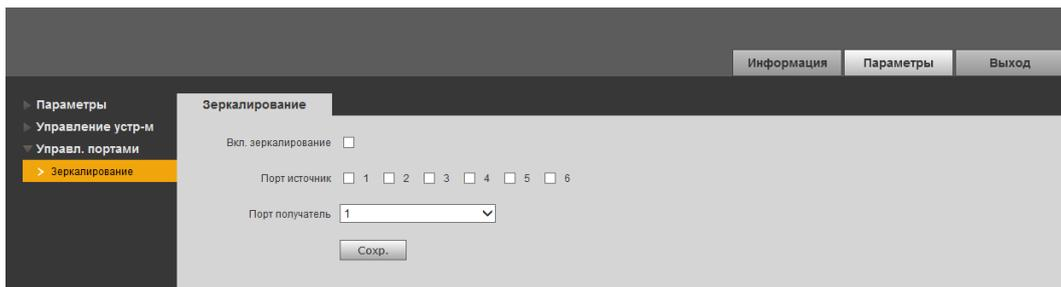
Рисунок 6.16 – Зеркалирование трафика
