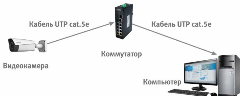
Рисунок 5.3 - Схема подключения видеокамеры к компьютеру через коммутатор
