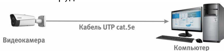
Рисунок 5.2 – Схема подключения видеокамеры к компьютеру
