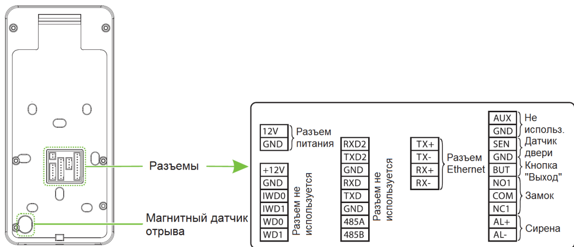
Рисунок 4. Схема расположения разъемов
