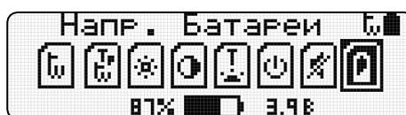
На дисплее в поле информации отображается текущее состояние аккумулятора в процентном соотношении и его напряжение.
