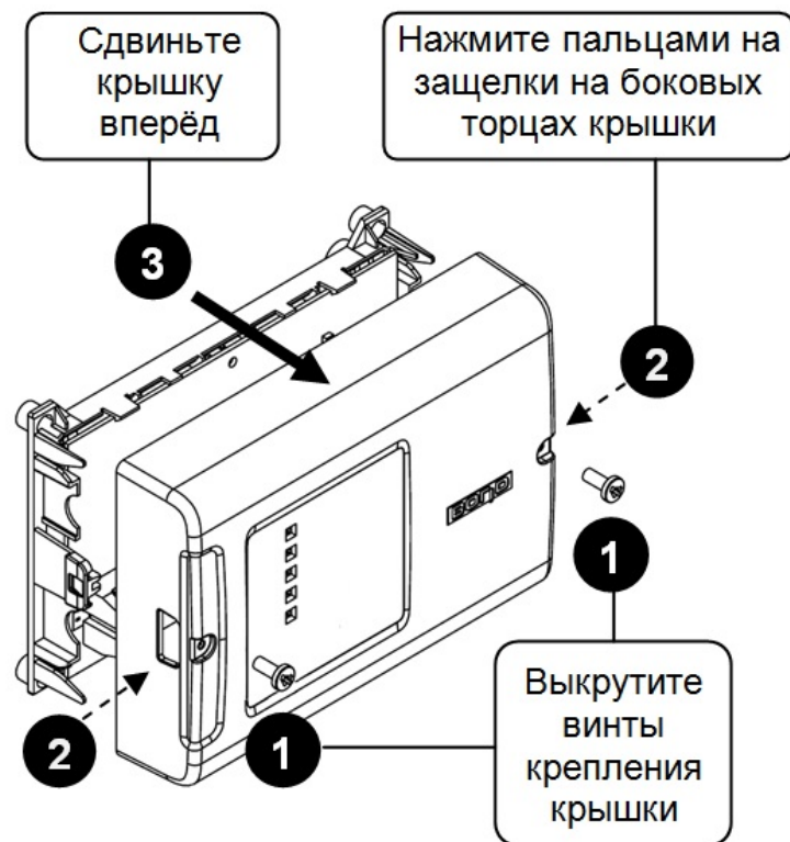
Рисунок 8-2 Снятие крышки
