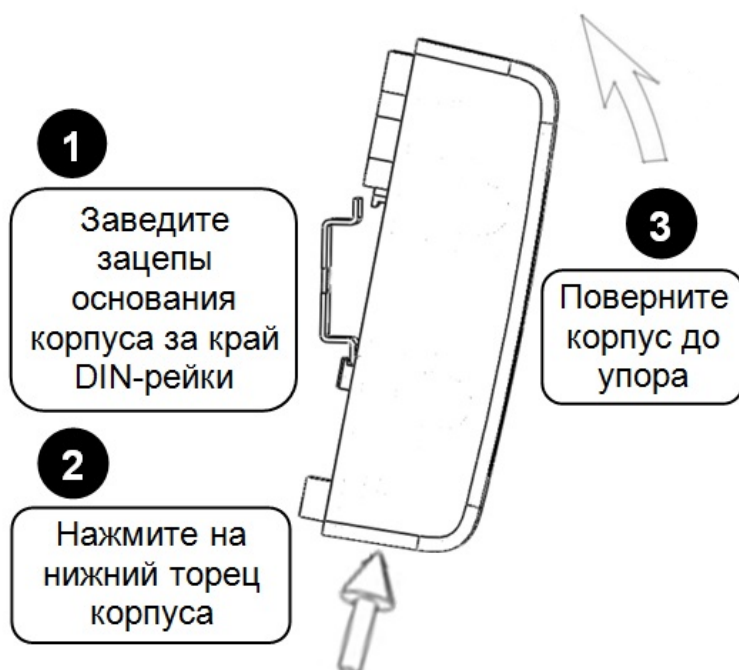
Рисунок 8-3 Крепление на DIN-рейку
