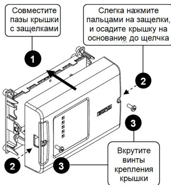
Рисунок 8. Монтаж крышки
