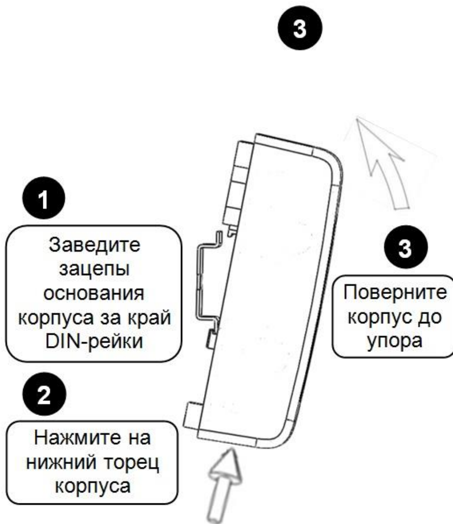
Рисунок 4. Крепление «УО-4С исп.02» на DIN-рейку
