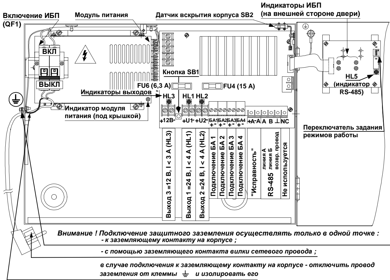
Рис. 3 Внешний вид ИБП-1224 исп. 2 с открытой дверью (подключение)
