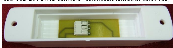
ИО 102-26 АЯКС исп.03/2 (клеммы экспрессмонтажа)
