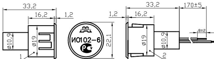
1.1.Извещатель охранный точечный магнитоcontactный переключающий ИО 102-6 П (далее – извещатель) предназначен для блокировки металлических дверных и оконных проёмов, сейфов, организации устройств типа «ловушка», а также блокировки других конструктивных элементов зданий и сооружений на открывание или смещение с выдачей сигнала «тревога» путём переключения контактов геркона на приёмно-контрольный прибор,
