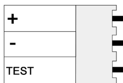
Рисунок 3. Назначение контактов разъема POWER
