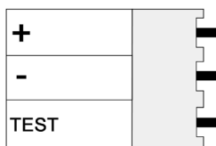
Рисунок 3. Назначение контактов разъема POWER
