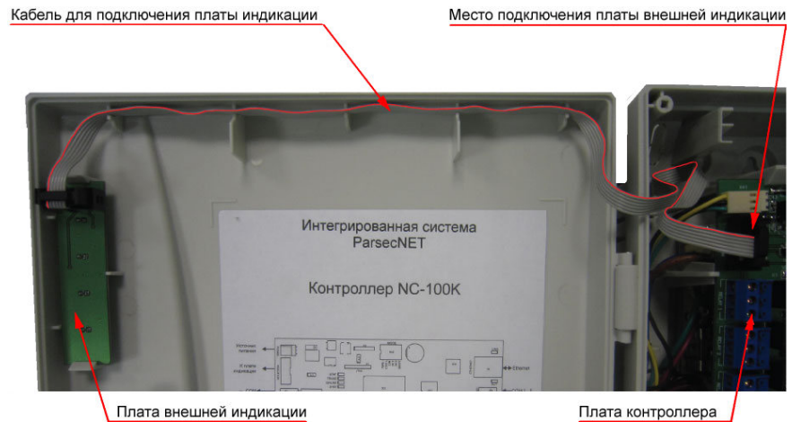
Рисунок 26. Подключение платы внешней индикации
