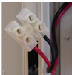
Рисунок 8. Клеммы для подключения дополнительного устройства к блоку питания
