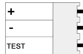
Рисунок 4. Назначение контактов разъема POWER
