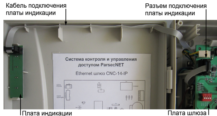
Рисунок 10. Подключение платы внешней индикации
