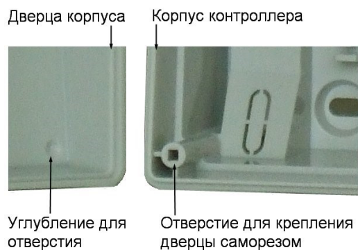
Рисунок 8. Схема «жесткого» крепления дверцы к корпусу контроллера
