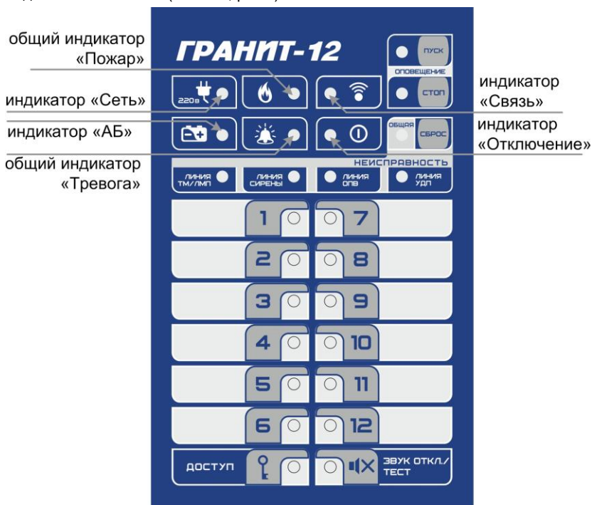
Рис.2 Панель индикации и управления прибора Гранит-12
