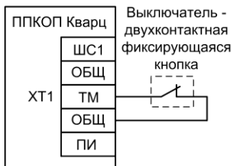
Рис.А3 Схема подключения выключателя
