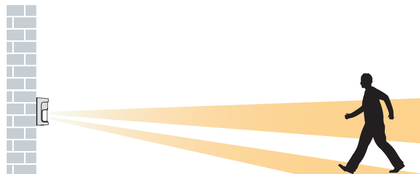
Стандартная установка на высоте 0,8 — 1,2 м
