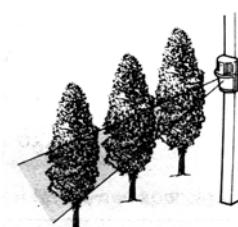
При установке избегайте движущихся объектов в зоне действия извещателя
