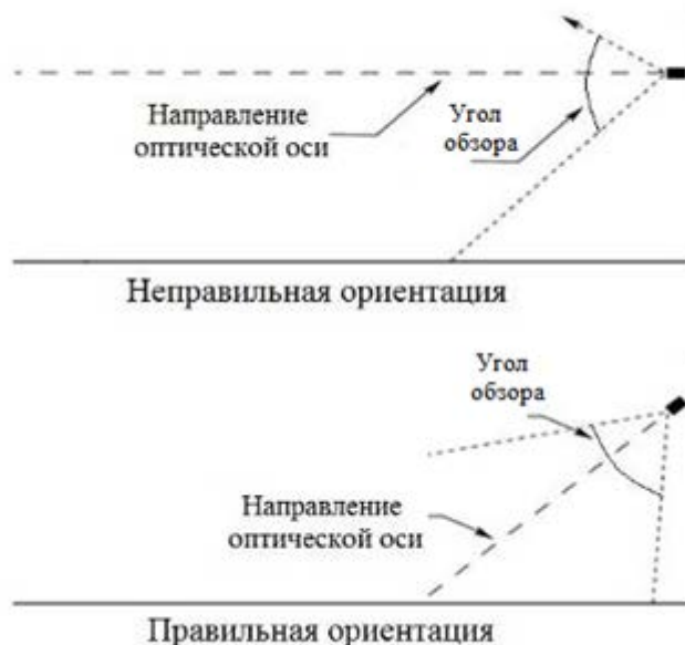
Рисунок 3 – Установка извещателя по отношению к горизонту
