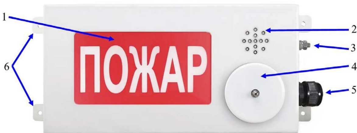
1 - табло (экран); 2 - звуковой излучатель; 3 - место заземления; 4 - крышка коммутационного отсека; 5 - кабельный ввод; 6 - крепежные отверстия (4 шт.).
