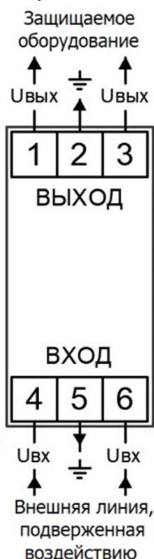
Рисунок 1. Схема подключения Спектрон-ГЗ-П
