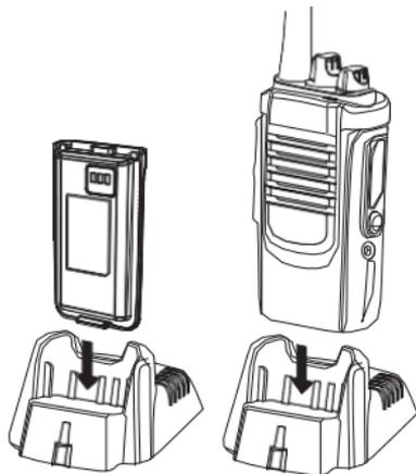
Зеленый светодиод загорается, указывая, что батарея полностью заряжена. Ориентировочное время полного зарядного цикла при комнатной температуре около 5 часов.
