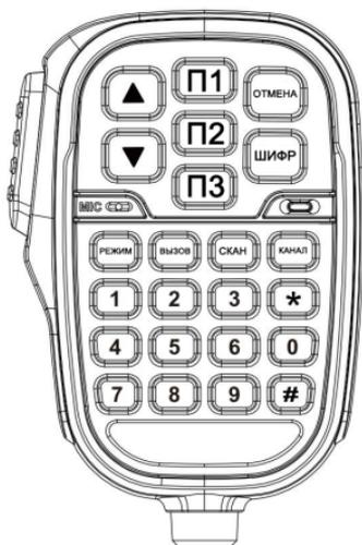
Нажатие клавиш на тангенте подтверждается звуковым сигналом высокого тона. При ошибочном нажатии или неправильно введённой команде вы услышите звук низкого тона.
