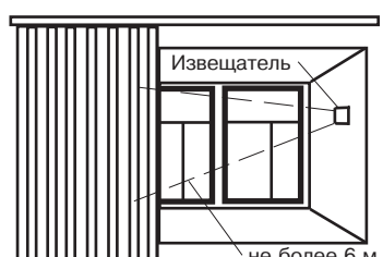
Рисунок 9 – Установка извещателя между стеклом и занавесями (жалюзи)
