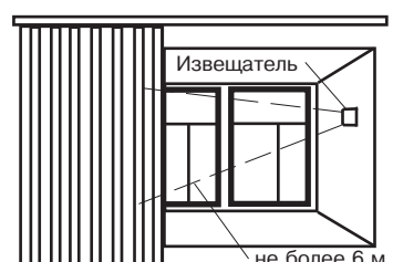
Рисунок 8 – Установка извещателя между стеклом и занавесями (жалюзи)
