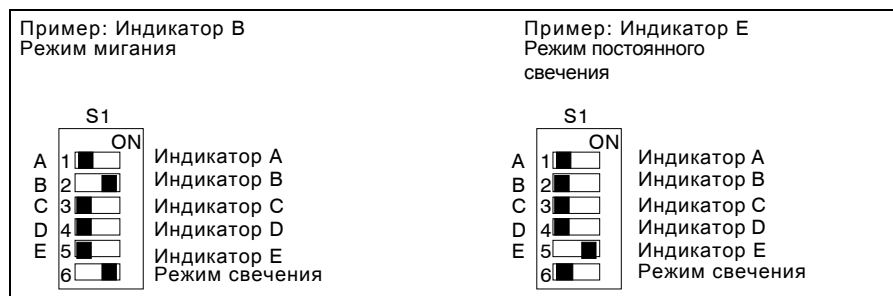
Рис. 5.27: Пример адресации внешних индикаторов
