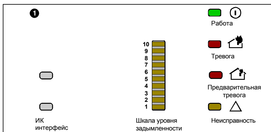
Рис. 2.13: Вариант индикации блока детекции со шкалой уровня задымленности (Пояснения см. №1 на следующей странице)
